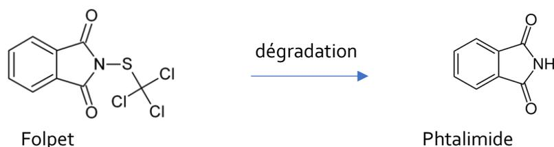
Figure 1 : Schéma de dégradation du Folpet en Phtalimide.
